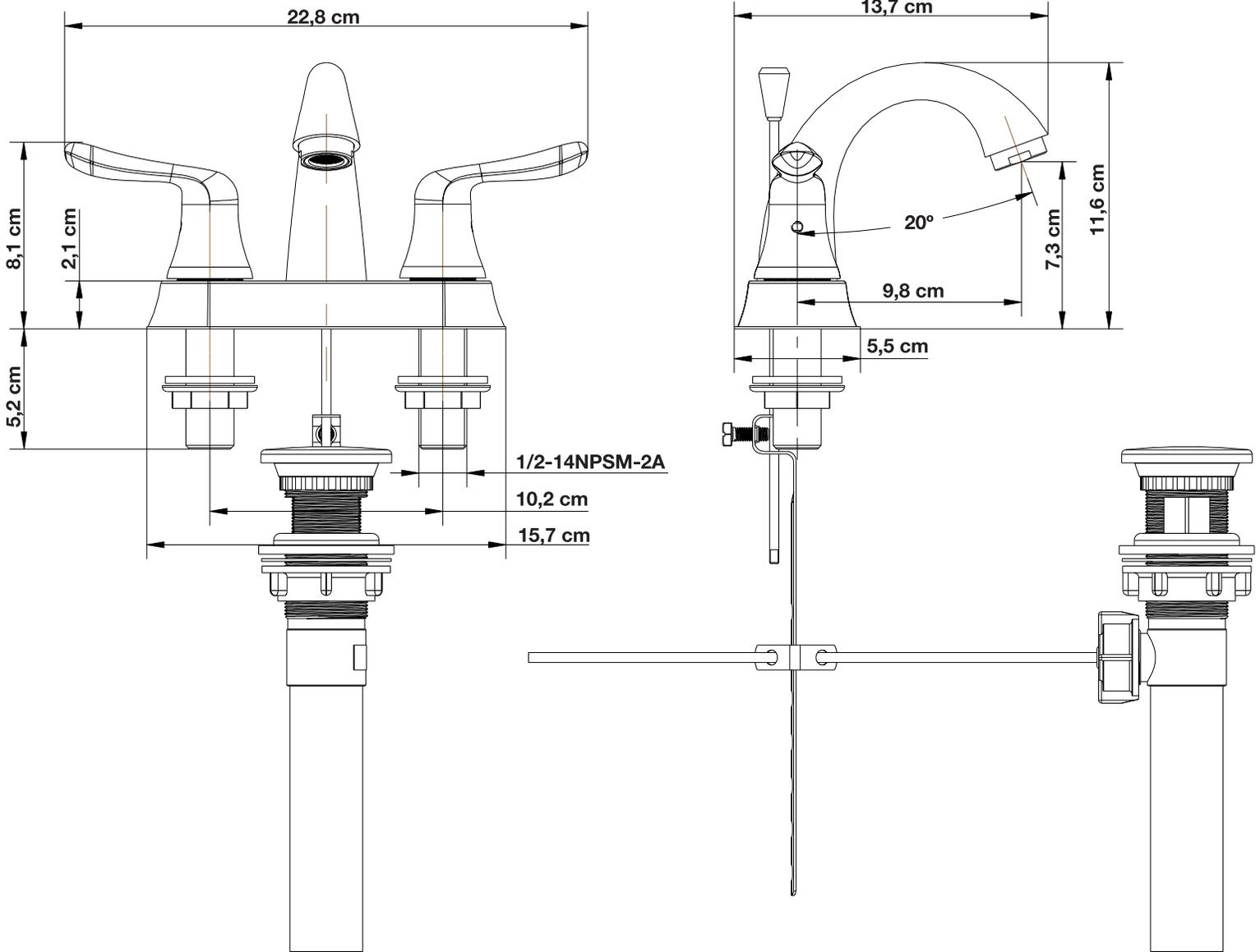
Toute ces dimensions sont approximatives. Afin d'assurer une installation parfaite, les dimensions de la structure doivent être vérifiées à partir de l'unité.
