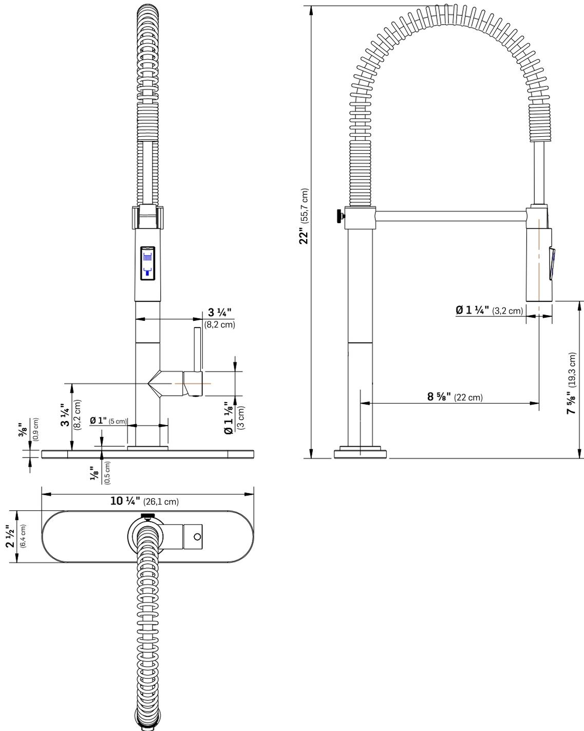
Toute ces dimensions sont approximatives. Afin d'assurer une installation parfaite, les dimensions de la structure doivent être vérifiées à partir de l'unité.
