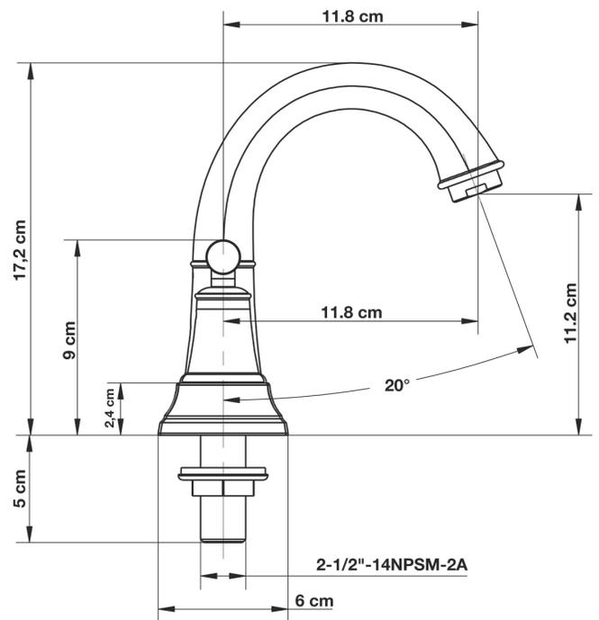
Toute ces dimensions sont approximatives. Afin d'assurer une installation parfaite, les dimensions de la structure doivent être vérifiées à partir de l'unité.
