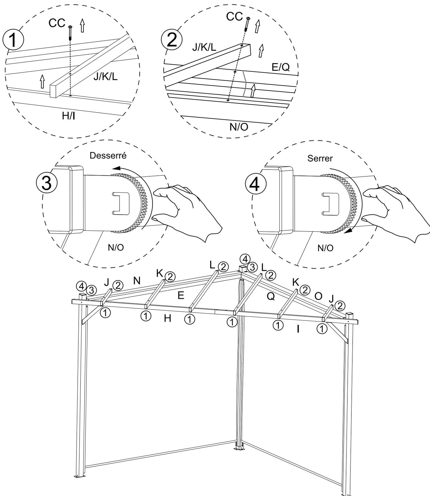
Prendre note : Si vous avez besoin d'ajuster la force du système, enlever les vis M6x70mm (CC), enlever les tubes de toit (J, K et L), ensuite enlever le couvre-panneau. Ensuite, tourner l'engrenage à la force appropriée. Ensuite, réassembler en vous fiant à l'étape 5.
