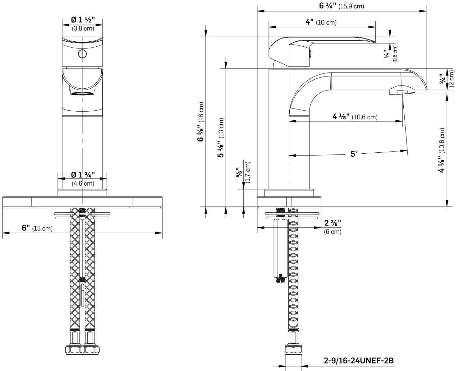
Toute ces dimensions sont approximatives. Afin d'assurer une installation parfaite, les dimensions de la structure doivent être vérifiées à partir de l'unité.
