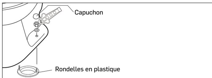
5. Insérez les vis d'ancrage dans le réservoir.
