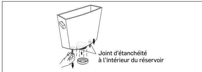
6. Serrez les vis alternativement jusqu'à ce que le réservoir soit bien à plat sur l'arrière de la cuvette.
