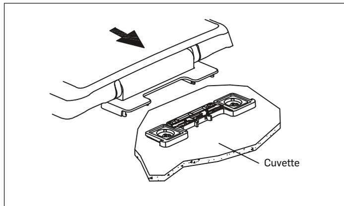
3. Démontage: Appuyez sur les blocs de charnière tel qu'illustré, puis faites glisser le siège (7) vers l'avant.
