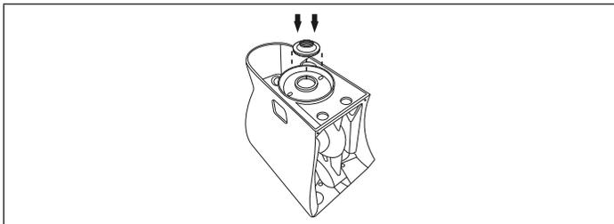
3. Appliquez du poids uniformément. Ne déplacez pas une fois positionné. Le joint d'étanchéité pourrait se briser.
