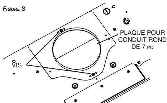
NOTE : La plaque pour conduit rond de 7 po peut être glissée latéralement, jusqu'à 1/2 po de chaque côté, pour s'ajuster à un conduit décentré.
