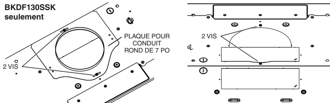
6 ] Retirer l'ouverture préamorcée du câble d'alimentation électrique du dessus (câblage vertical) ou de l'arrière de la hotte (câblage horizontal). Installer un serre-fils approprié de 1/2 po de diamètre (non inclus).
