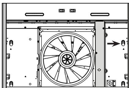
5 ] **BKDF130SSK seulement** : Retirer la plaque pour conduit rond de 7 po du dessus de la hotte (voir l'illustration ci-dessous). Garder les vis pour usage ultérieur.
