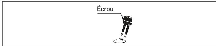
2. Poussez l'assemblage du bouton-poussoir par le couvercle du réservoir. Mettez l'écrou en place et le serrer (Ne serrez pas trop).
