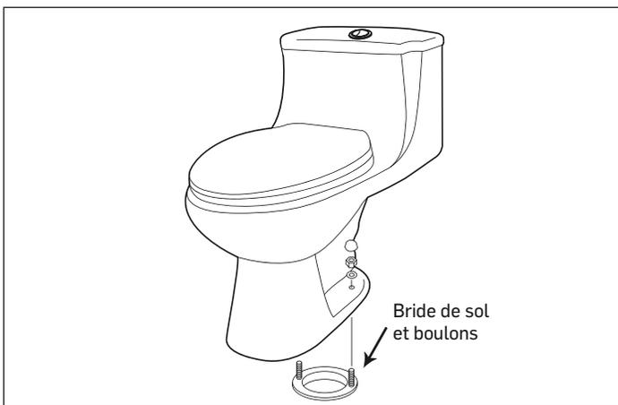
3. Exercez une pression ferme sur la cuvette en la remuant légèrement dans tous les sens afin d'assurer une parfaite adhésion. L'excès de cire sortira sous pression tandis que la cuvette prendra sa position finale. Installez les rondelles et les écrous sur les boulons et serrez-les bien. Recouvrez les écrous avec capuchons remplis de mastic de plombier.
