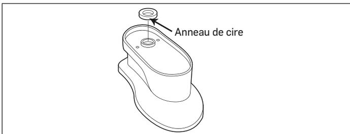
2. Insérez deux boulons neufs dans les trous de la bride de sol, en utilisant du mastic au besoin pour les maintenir en position verticale. Appliquez du mastic de plombier sur le pourtour de la base de la cuvette. Saisissez et retournez la cuvette, puis déposez-la délicatement au-dessus des boulons verticaux de la bride de sol. L'anneau de cire doit s'emboîter parfaitement dans la bride de sol.
