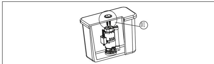
4. Les tiges pour chasse pleine et demi-chasse peuvent être ajustées en haut ou en bas en tournant les tiges dans le sens horaire (HAUT) et dans le sens anti-horaire (BAS).
